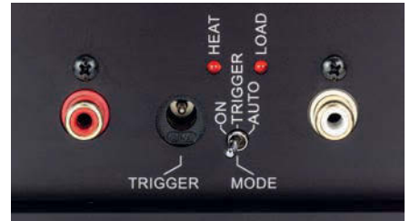
Hier der Triggeranschluss – die LEDs zeigen Überlast/Überhitzung an
