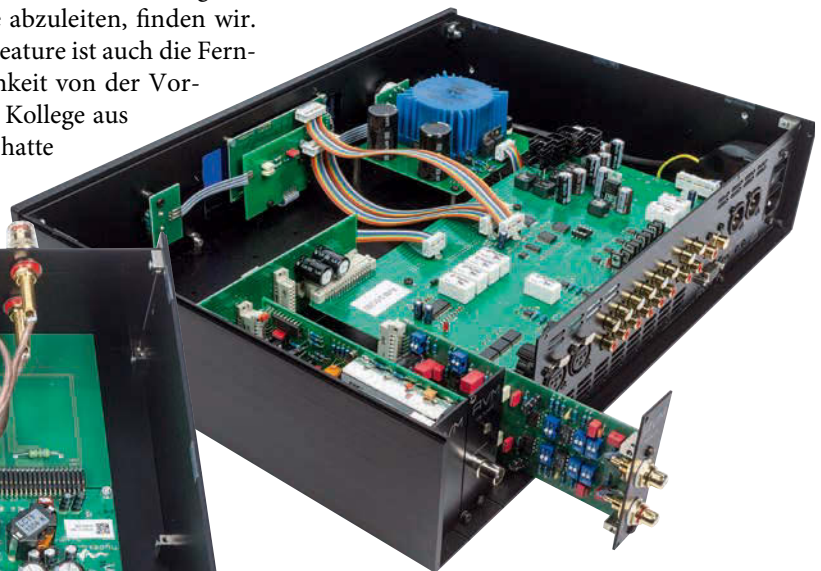
Schubkraft: Drei Steckmodule finden im Vorverstärker Platz, herausgezogen die anpassbare Phonoplatine
